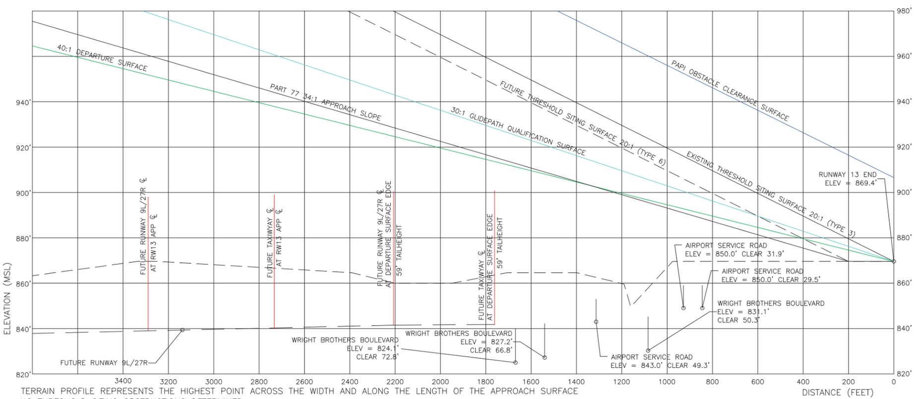
TERRAIN PROFILE REPRESENTS THE HIGHEST POINT ACROSS THE WIDTH AND ALONG THE LENGTH OF THE APPROACH SURFACE
